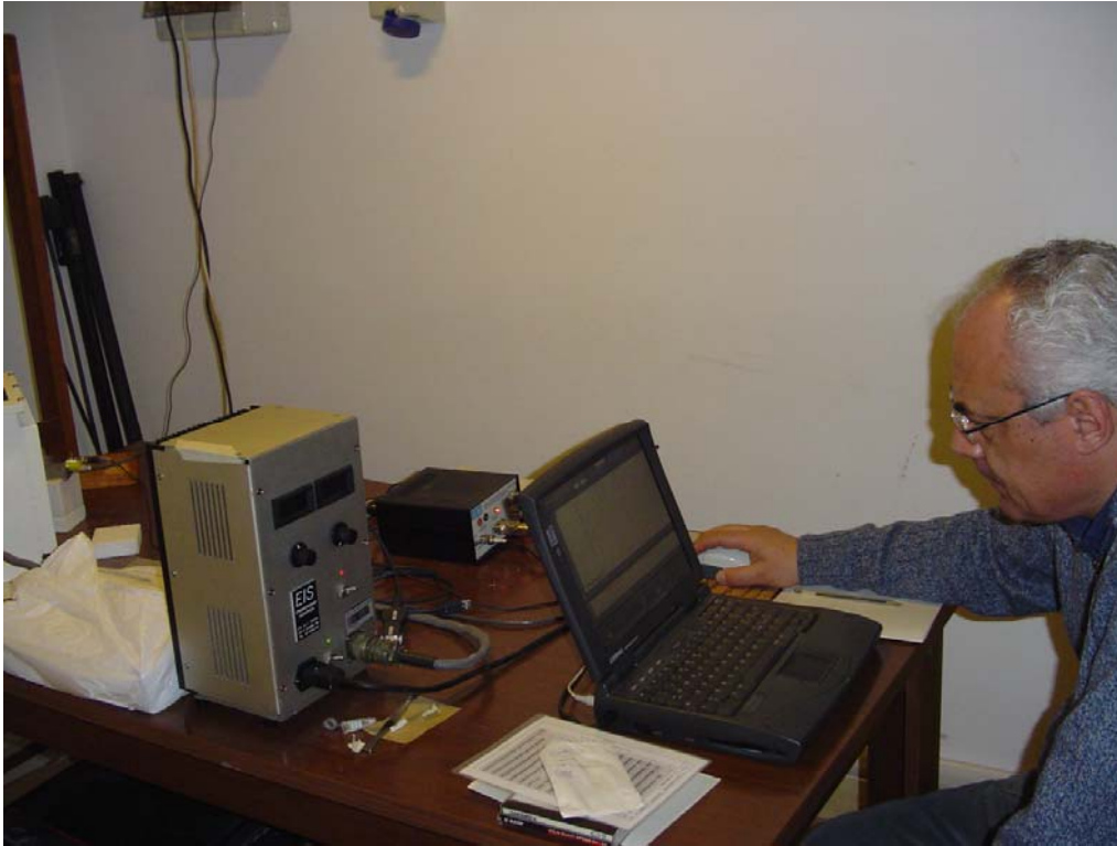
La strumentazione portatile di XRF utilizzata per le misure sui materiali delle Marche.
