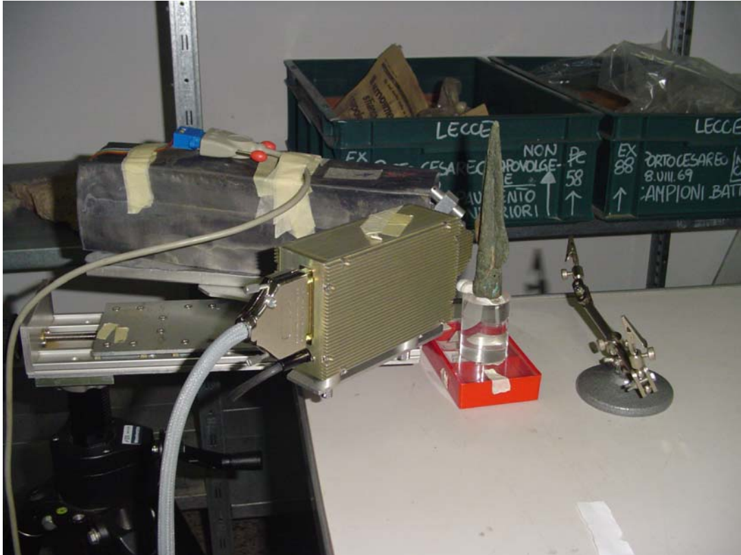
La strumentazione portatile di XRF mentre misura una punta di lancia dal Museo di Taranto
